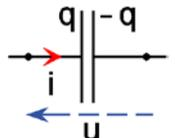
La charge  $q$  est, par convention la charge portée par la plaque par laquelle on entre dans le condensateur.
