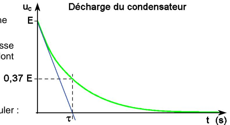
**Exemple** : Pour un circuit formé d'un conducteur ohmique de résistance  $R = 100 \Omega$  et d'un condensateur de capacité  $C = 1 \mu\text{F}$ , on a :  $\tau = R \cdot C = 10^{-4} \text{ s} = 0,1 \text{ ms}$ .
